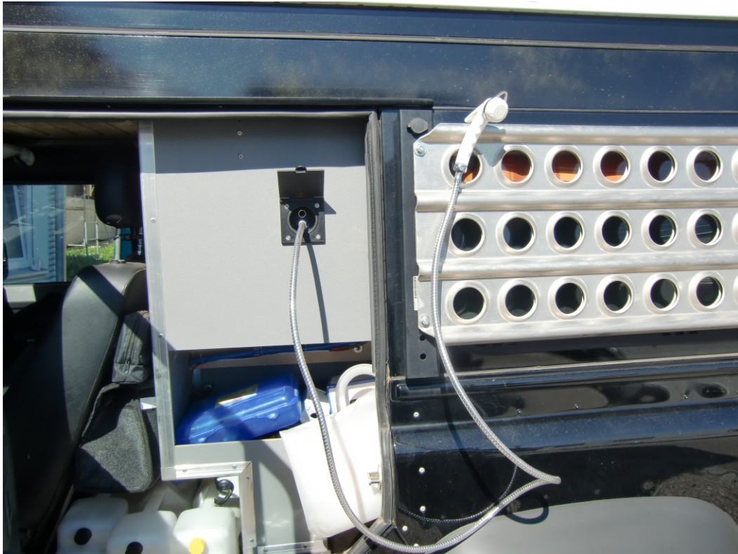
Fahrerseite: An der Rückseite des Spülenschranks eine Außendusche. Unten links einzelne Wassertanks.
