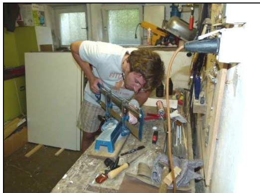
Richard: Arbeit am „Feinschliff“ mit einem unserer wichtigsten Werkzeuge: der Gehrungssäge.
